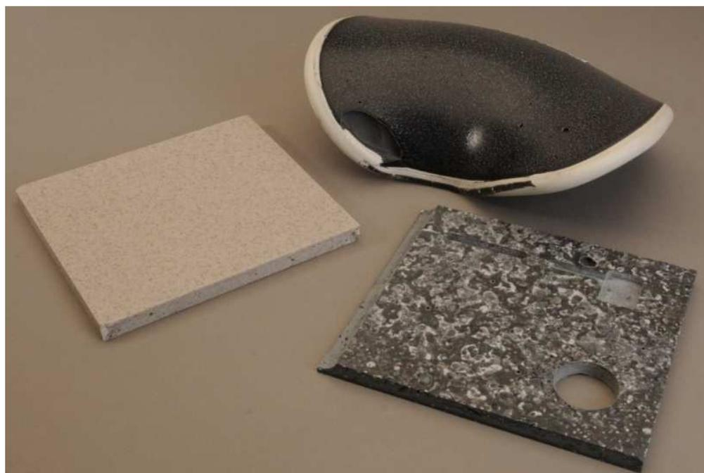
L' eccellente proprietà di termoformatura permette la produzione di oggetti di design di geometria complessa.
