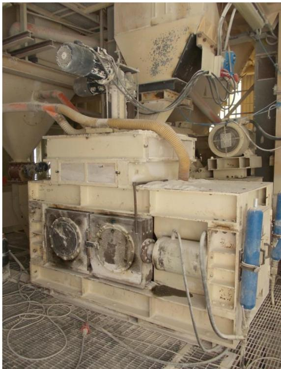
2) presa in consegna del prodotto essiccato e riduzione progressiva in polvere a 100 micron di dimensione attraverso l'utilizzo di cilindraie ad alta pressione e successivo insaccamento in big-bags.
